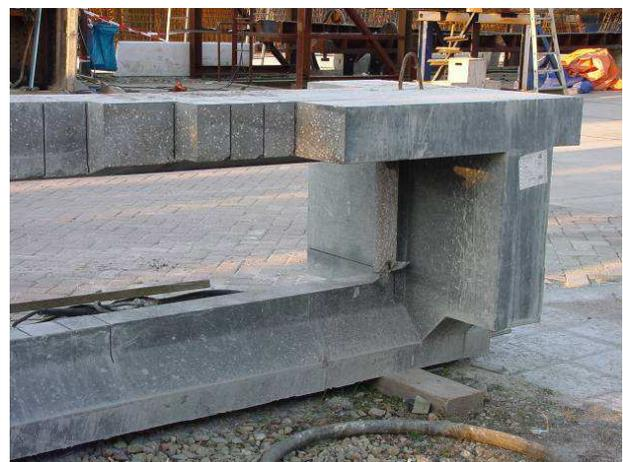
Figure 9 : élément témoin pour le pont de Bourg les Valence en BSI®, vue avant et après sciage
