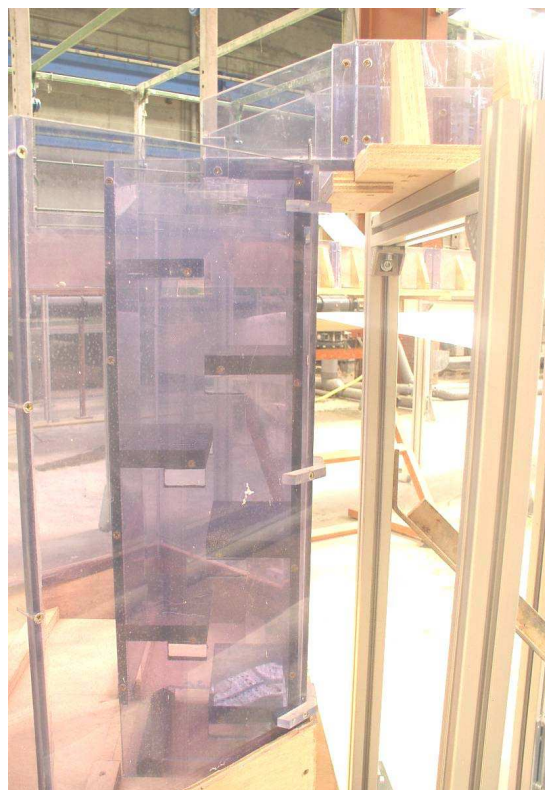
Puits de chute à Paliers
