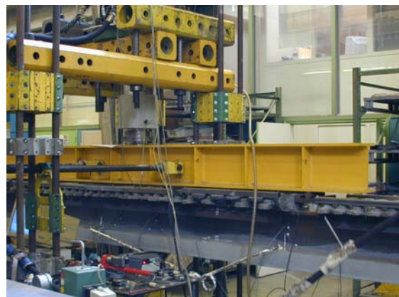
Figure 16: Schematic showing the fatigue test on Beam 2 / Montage réalisé pour l'essai de fatigue sur la poutre 2
