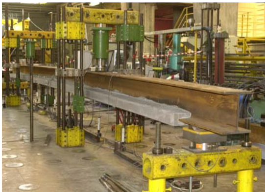
Figure 4 : Mise en précontrainte à 48 heures d'âge du béton de la poutre mixte Transfer of prestressing at 48 hours of concrete age of the composite beam.
