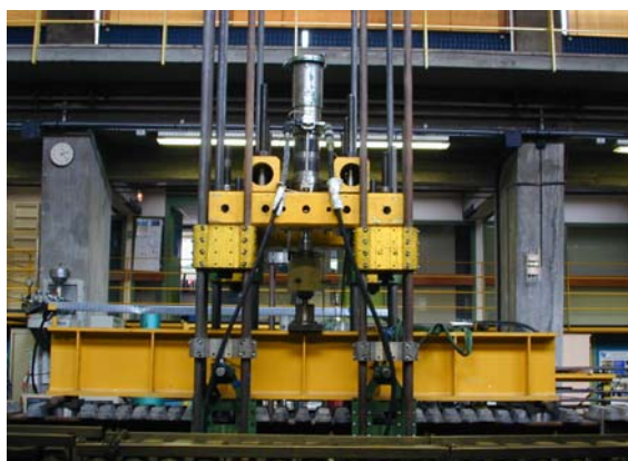
Figure 15 : Montage réalisé pour l'essai de fatigue sur la poutre 1 Schematic showing the fatigue test on Beam 1
