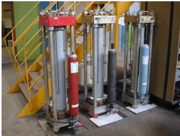
Figure 8 : Essais de fluage en environnement variable à proximité des poutres / Creep tests in variable environment near the beams.
