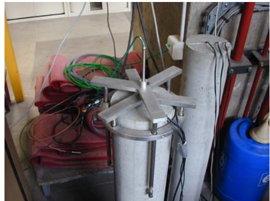
Figure 9 : Shrinkage tests in variable environment near the beams / Essais de retrait en environnement variable à proximité des poutres.
