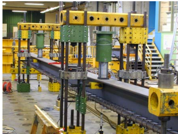
Figure 2: Prebending of the steel girder au LCPC. Préflexion du profilé métallique au LCPC.
