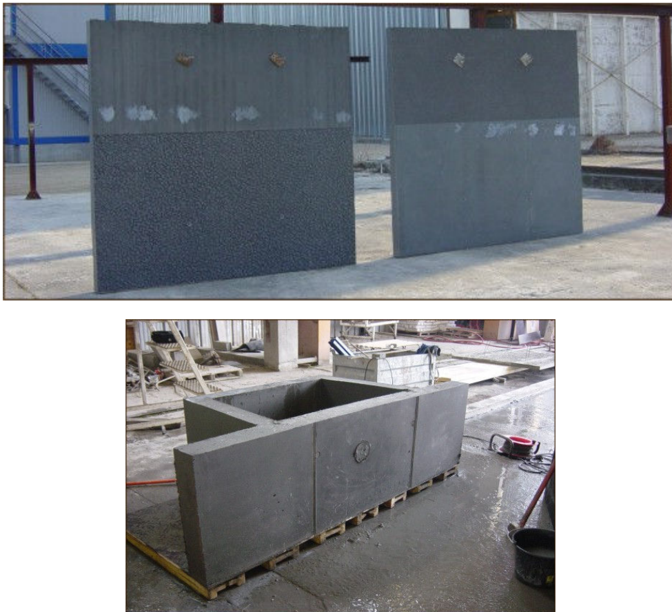
Fig. 7 : Panneaux et mini voussoir d'essais / Panels and mini testing segment
