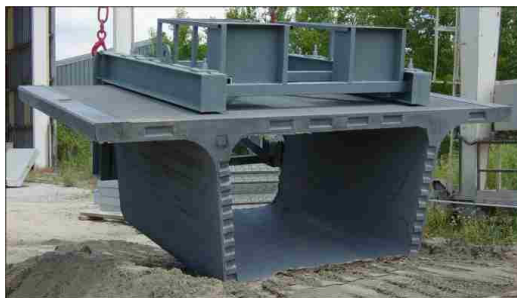
Fig. 9 : Voussoir d'essais en vraie grandeur / Actual size testing segment
