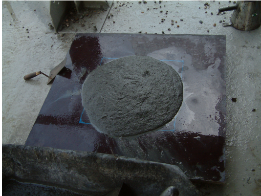
Fig. 6 : Test d'étalement (sans chocs) Flow test (without shocks)
