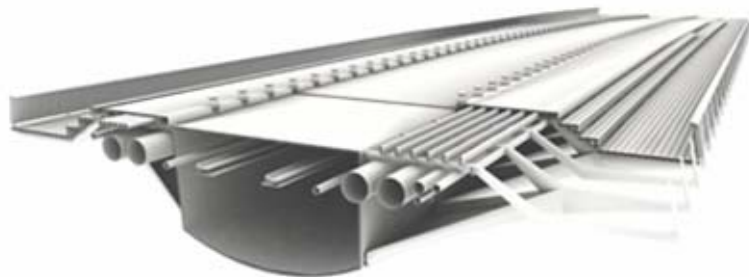
Figure 2 : Coupe type du tablier
