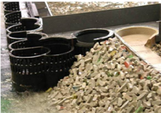
Fig 7 : Jonction entre les Accropodes et les caissons / Junction between Accropodes and caissons
