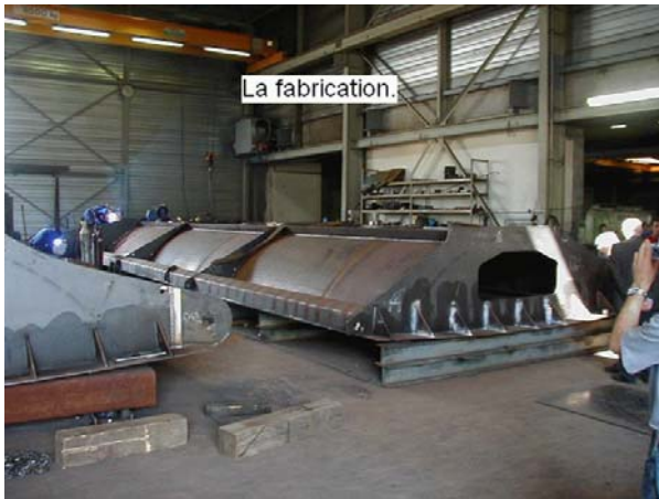
Fabrication et pose des clapets
