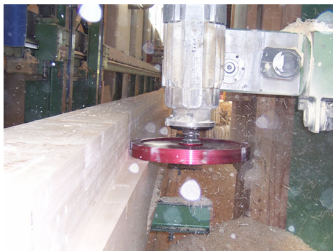
Fraisage des contours des planches
