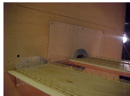
Montage permettant la pesée d'une seule maquette, l'autre servant de "masque"
