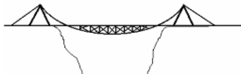
Pont treillis suspendu (Ingérop/Berger)
