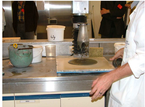
Au laboratoire de Vicat : test d'étalement sur prémix non fibré, réalisé pour l'assemblé
