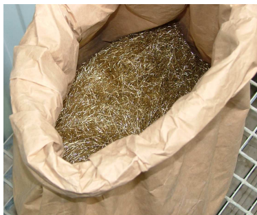
Les fibres, conditionnées en sac avant d'être ajoutées au prémix
