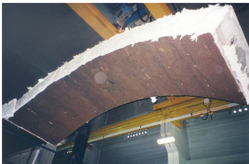
Voussoir bi-couche pour tenue incendie des tunnels
