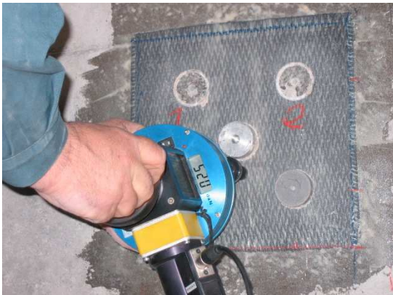
Essai d'arrachement Freyssinet
