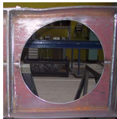
Figure 8 - Essai 1ar - ruine par effet Vierendeel
