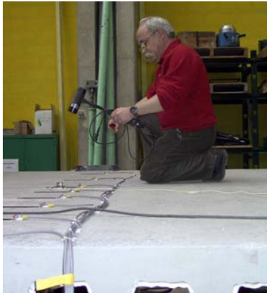
Figure 15 - Mesure de la fréquence de la poutre 4m et réponse en accélération
