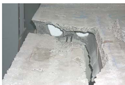
Figure 16 – Rupture lors de l'essai n° 1
