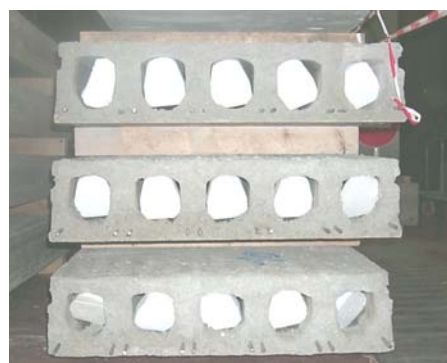
Figure 6 – Section des dalles alvéolées
