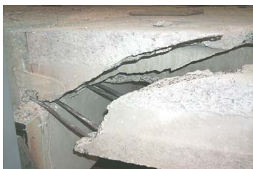
Figure 16 – Rupture lors de l'essai n° 1
