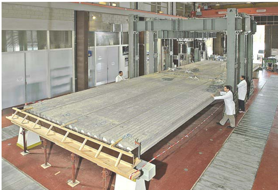
Figure 8 – Vue d'ensemble du plancher avant la mise en place du dispositif de chargement
