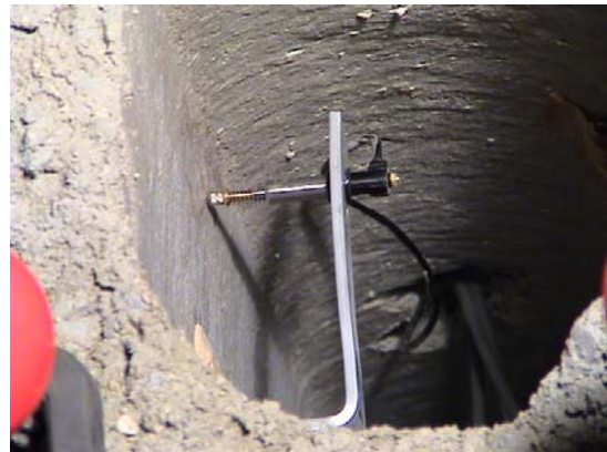
Figure 13 – Dispositif de mesure du gauchissement
