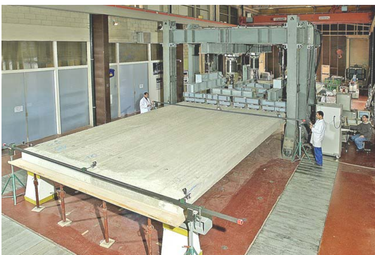
Figure 12 – Vue d'ensemble du plancher prêt à être testé
