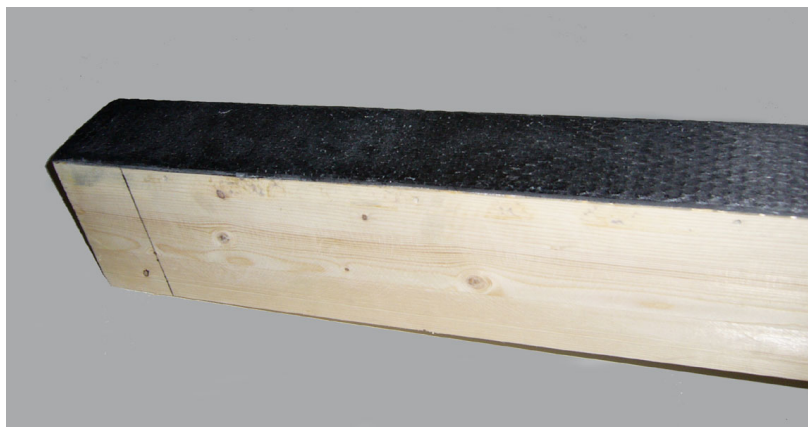
Figure 8. Exemple de poutre LC renforcé par du tissu collé sous vide (ENPC)
