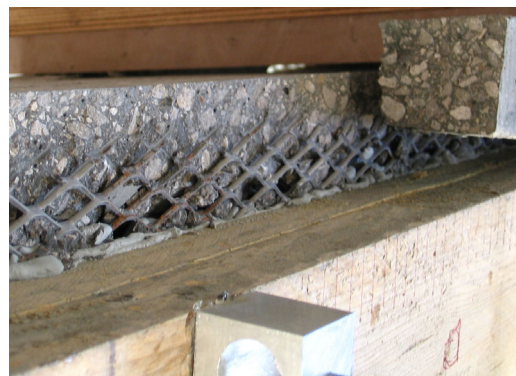
Figure 9. Glissement à l'interface à l'extrémité et la rupture en cisaillement dans le béton
