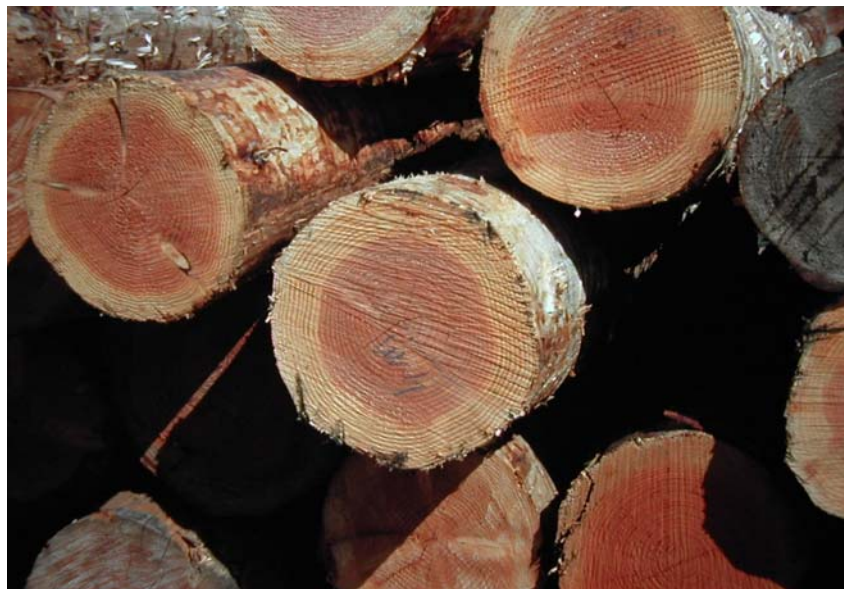
Section d'un tronc de Douglas (Duramen orange, aubier jaune)
