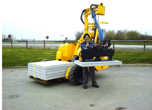
Figure 14 : Pose mécanisée de produits de voirie
