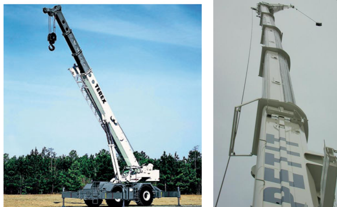
Fig. 12 : flèche télescopique composée de 2 demi-coquilles soudées bord à bord Noter les plis sur la face en compression améliorant la résistance au flambement
