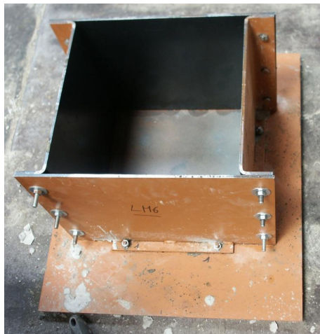
Figure 4 : Moule avec paroi neuve
