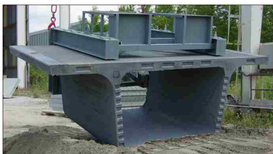
Fig. 9 : Voussoir d'essais en vraie grandeur et position des prélèvements (les flèches indiquent les faces testées lors des essais de flexion)
