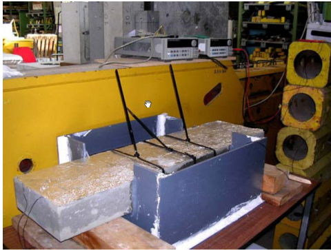
Figure 15 : Montage de l'essai de corrosion intensifié (LCPC)
