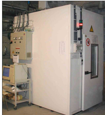
Figure 23. Vieillessement des dalles (CSTC)
