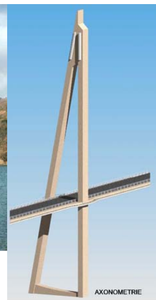
Figure 26 - Solution avec tablier encastré et pylône en forme de A dissymétrique
