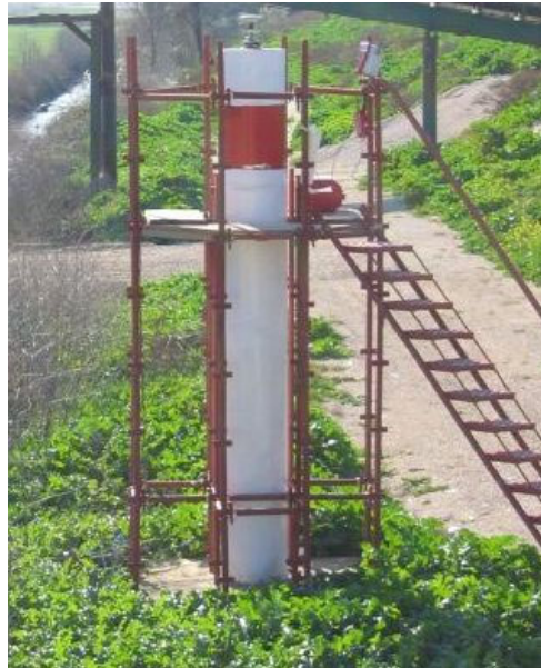
Figure 4 – Une technique très récente : GPS différentiel. Un pilier de référence pour la construction du pont de Carregado au Portugal
