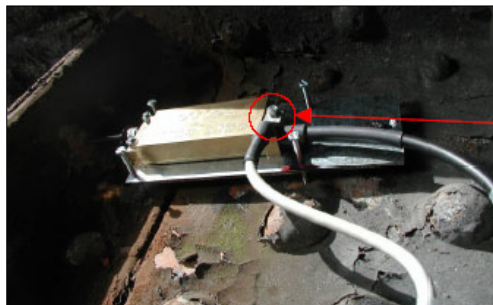
Ci-dessus: Extensomètre optique sur plaque de fixation
