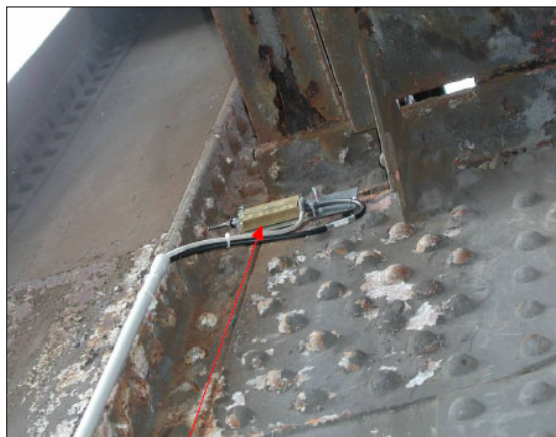
Ci-dessus: Extensomètre optique sur plaque de fixation
