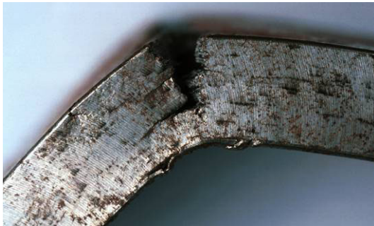
Essais de pliage de fer puddlé
