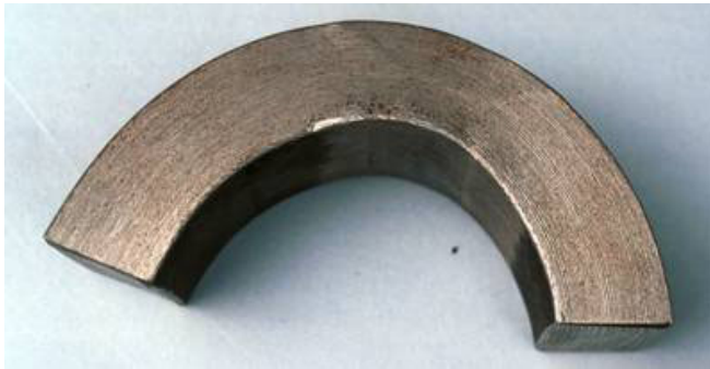
Essai de pliage d'acier moderne
