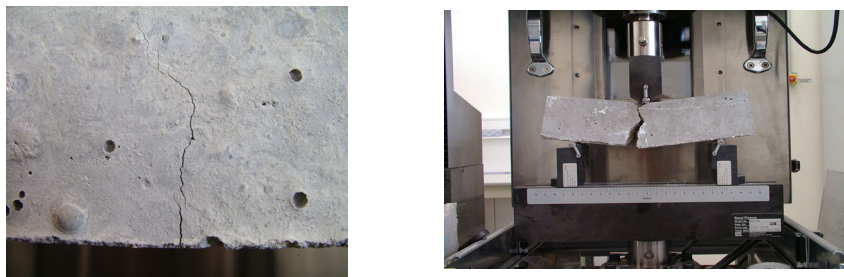
Fig.8 Propagation des fissures d'une poutre renforcée
