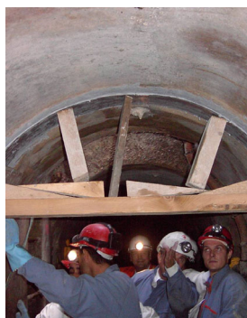
Photo 1 : Essai de collage in-situ – Mise au point d'un système d'étalement
