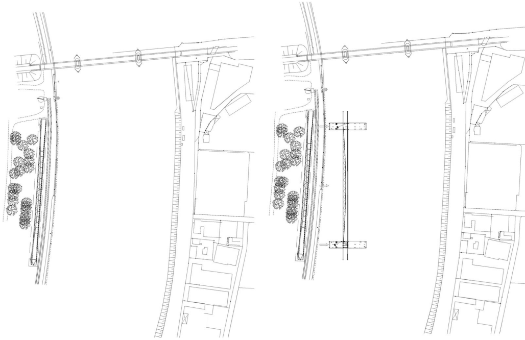
Ripage de la passerelle sur les barges
