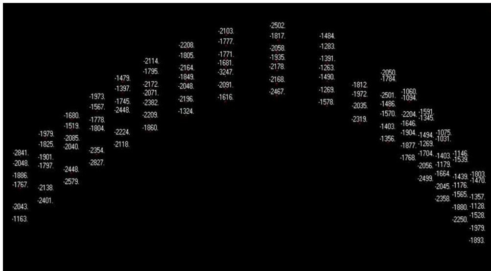
Exemple d'efforts de compression maxi entre panneaux de PM (unité : kN)
