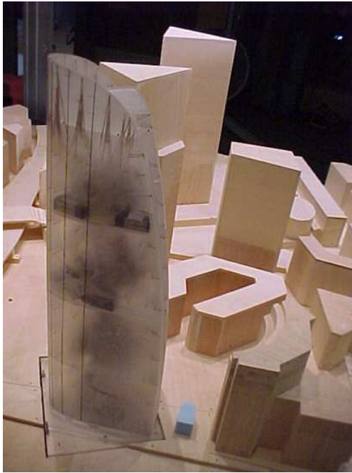
Maquette de la Tour T1 : Rigide en plexiglas échelle 1/200e - Façades Nord & N/O et Bâtiments proches
