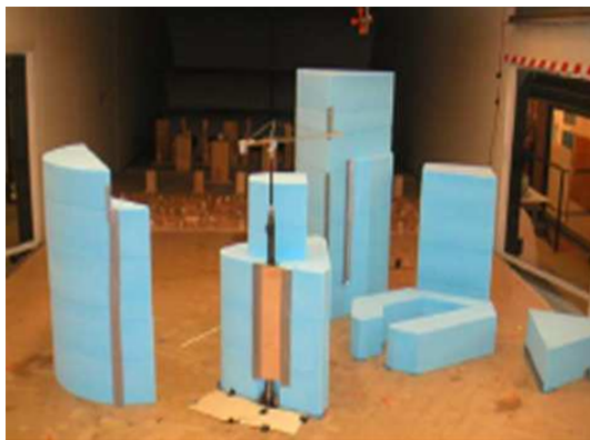
Photo de la maquette pour les essais en soufflerie au CSTB.
