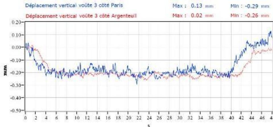
Comparaison des déplacements calculés avec les mesures sur site sous trafic
