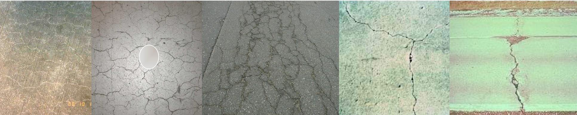
Retraits et gonflements ne sont **pas uniformes** (*gradients*) mais sont **isotropes** (non orientés), ce qui génère des fissures de type **faïençage**.
