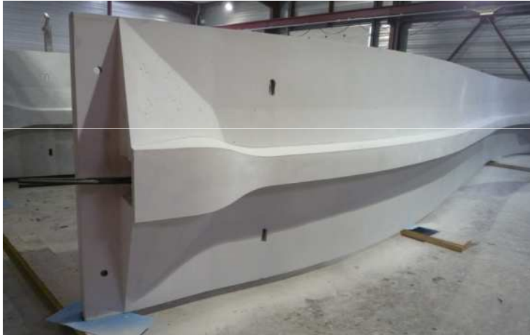
Stockage des pièces en attente de post-contrainte
