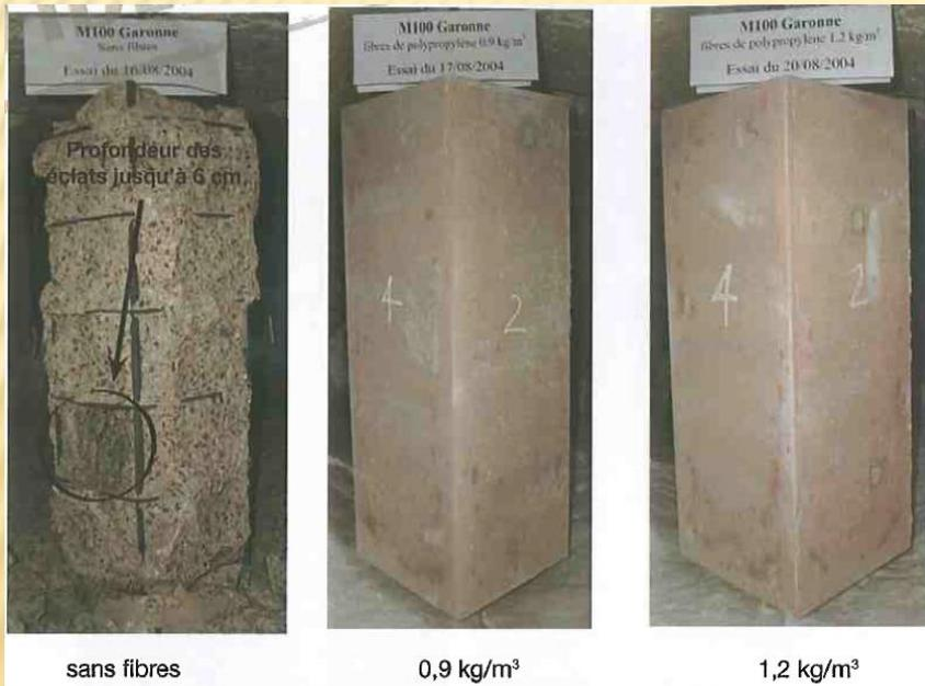
Perméabilité intrinsèque du béton fibré en fonction du dosage au point de dégradation des fibres PP des essais de l'ATILH (1)
