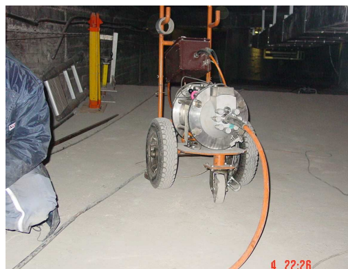
Photo 13 : Appareil de type GR50 utilisant une source légère de cobalt 60 pour les clichés de gammagraphie GR50 apparatus with light cobalt 60 source for gamma ray photographs
