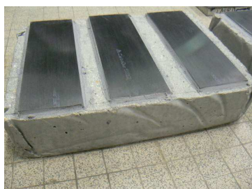
Fig. 6. Echantillon en béton renforcé avec trois couches de composites en lamelles
