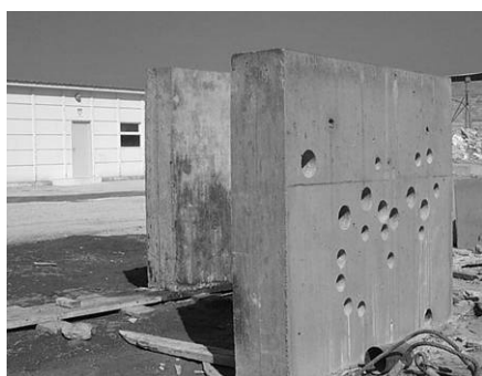
Figure 21: fabrication de voiles tests avec les différentes formules dérivées en BHP lors des épreuves de convenance
