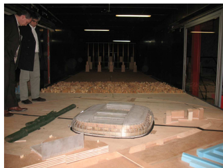
Maquette d'essais au vent au CSTB à Nantes
