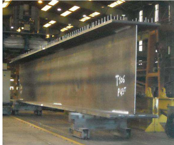
Tronçon d'une poutre réalisée en usine
