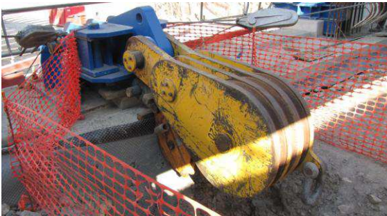
Poulie utilisée pour le lançage
