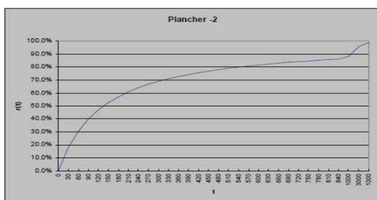
Figure 38 : Analyse temporelle du fluage du plancher d'infrastructure du 2 nd étage
