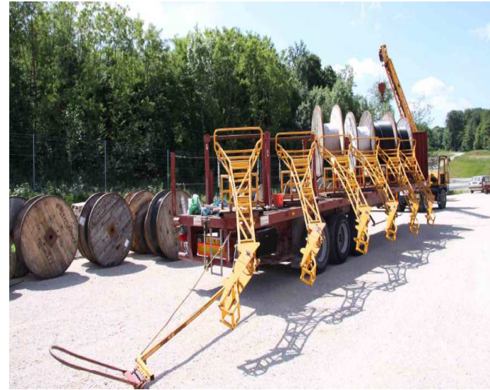
Déroutage de câbles
