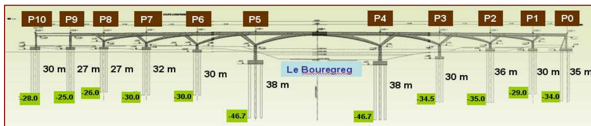
Fig. 3. Coupe longitudinale générale / General longitudinal section
