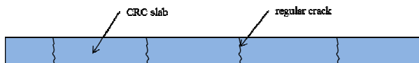
Fig. 1 Répartition des fissures dans une dalle BAC / Crack distribution in CRC slab
