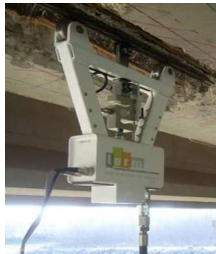
Figure 4 : Réalisation d'un essai à l'arbalète / Development of a test crossbow
