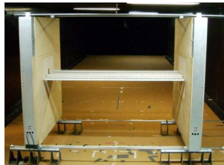
Schéma de principe des écoulements autour du caisson, et vérification par maquette en soufflerie
