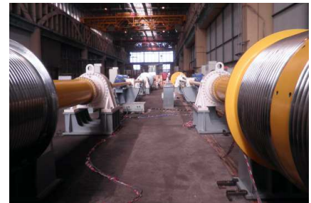
Essais à vide en usine des deux lignes d'entraînement
