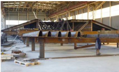
Les travaux de charpente en atelier : caisson principal de la travée levante et consoles support des passerelles
