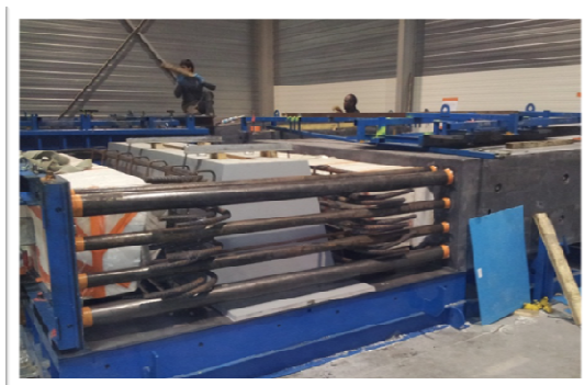
Photo 6 : Voussoir fenêtre avec armatures de renfort et noyaux spécifiques © Eiffage TP
