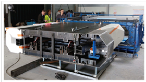
Photo 4 : Noyau décintrable avec abouts polystyrène et acier © H. Abbadie
