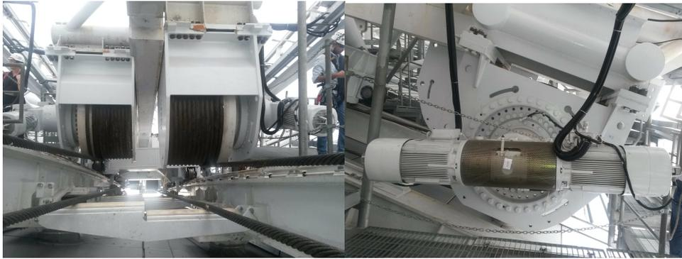
Fig.13. Treuils fixés sur la partie mobile, suspendus à la structure métallique et équipés de deux moteurs électriques.
