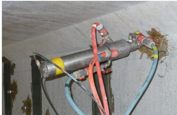
Figure 12 : transducteur ultrasonore d'injection d'inhibiteur de corrosion dans les gaines de précontrainte
